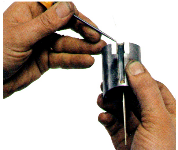
Abbildung 10: Ausschnitt und Rampe des Gasschiebers sind aufeinander abgestimmt. Das Rampenprofil steuert die Arbeit des Beschleunigerpumpe
