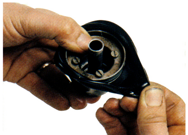
Abbildung 15: Visuelle und manuelle Kontrolle der Membrane auf Beschädigungen
