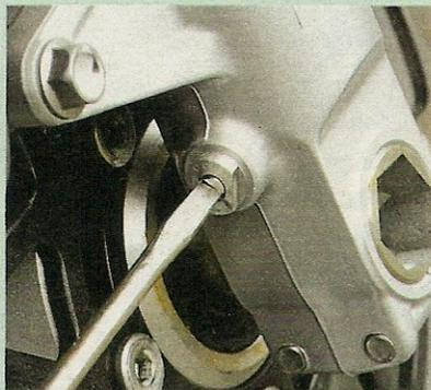
Die Druckstufendämpfung wirkt beim Einfedern und lässt sich unten am Bodenventil einstellen
